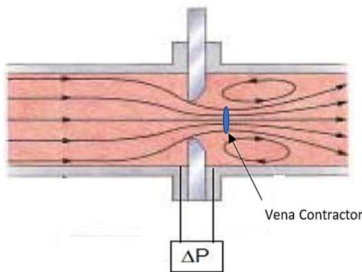
Figure 2. Orifice Plate Meter
